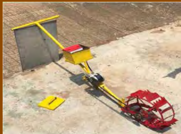
चित्र 2.13: चावल की फसल के लिए बैटरी चालित वीडर
