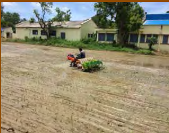
चित्र 2.12: मैकेनिकल धान प्ररोपक में लगे यूरिया ब्रिकेट एप्लिकेटर
